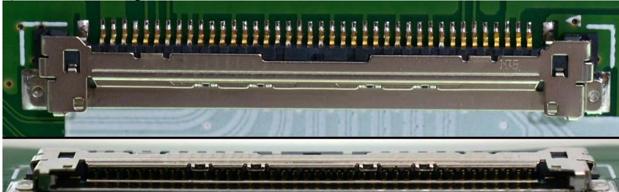
б) **30 пин широкий разъем с шагом 0,5мм (старый разъем используется вместе с ламповыми матрицами или на матрицах мониторов)**
